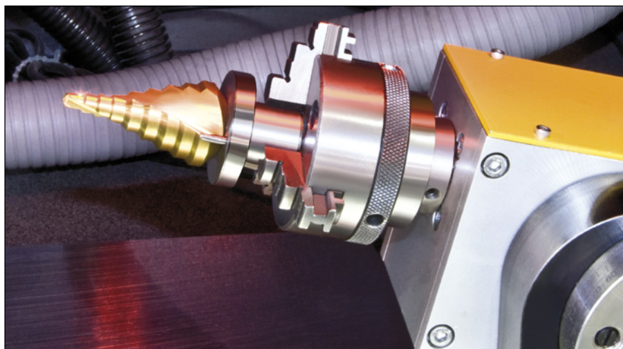
5. Punta de la broca rectificada por el procedimiento CBN y con split point según DIN 1412 C
